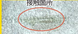
砥石より柔らかい樹脂製パットがガードの役割をし、大幅に被害を軽減!
