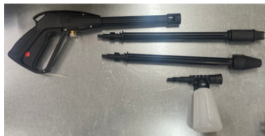
高圧洗浄ガン&洗浄ノズル 角度可変ノズル(上) 回転ノズル(中) 洗剤ノズル(下)
