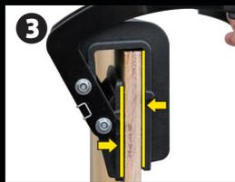
③ Gripperプレート全面が板に密着しているか確認。
