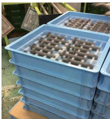
金属部品を多数収納してもたわみにくい底面強度を有します。
