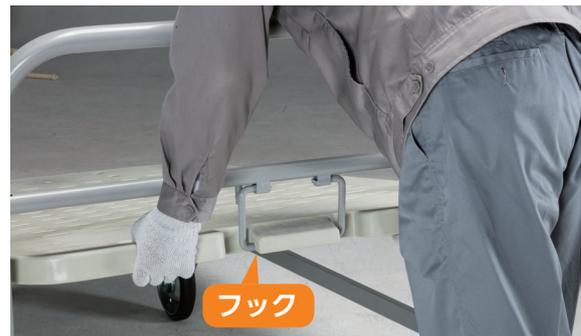
積載面は軽量のため楽に持ち上げることができます。また、持ち上げるだけでフックに固定されるため、ネスティング作業時の操作性に優れます。
