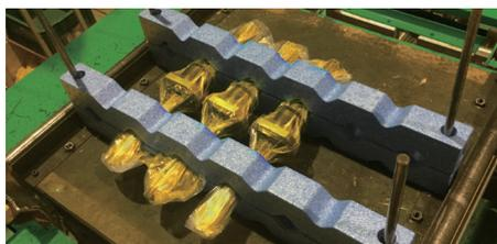
長尺の金属部品等を乗せるエペラン製枕木です。低倍率の原料を使用することで重い金属部品を支え、最適な緩衝性能を発揮。金属部品を傷付けることなく保管が可能です。
