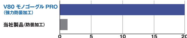
●試験方法: レンズに水蒸気を3秒間当てたのち拭き取る作業を繰り返し、曇りが発生するまでの回数を計測。
