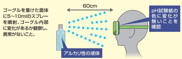
●試験方法: ANSIの液体気密試験による評価。
