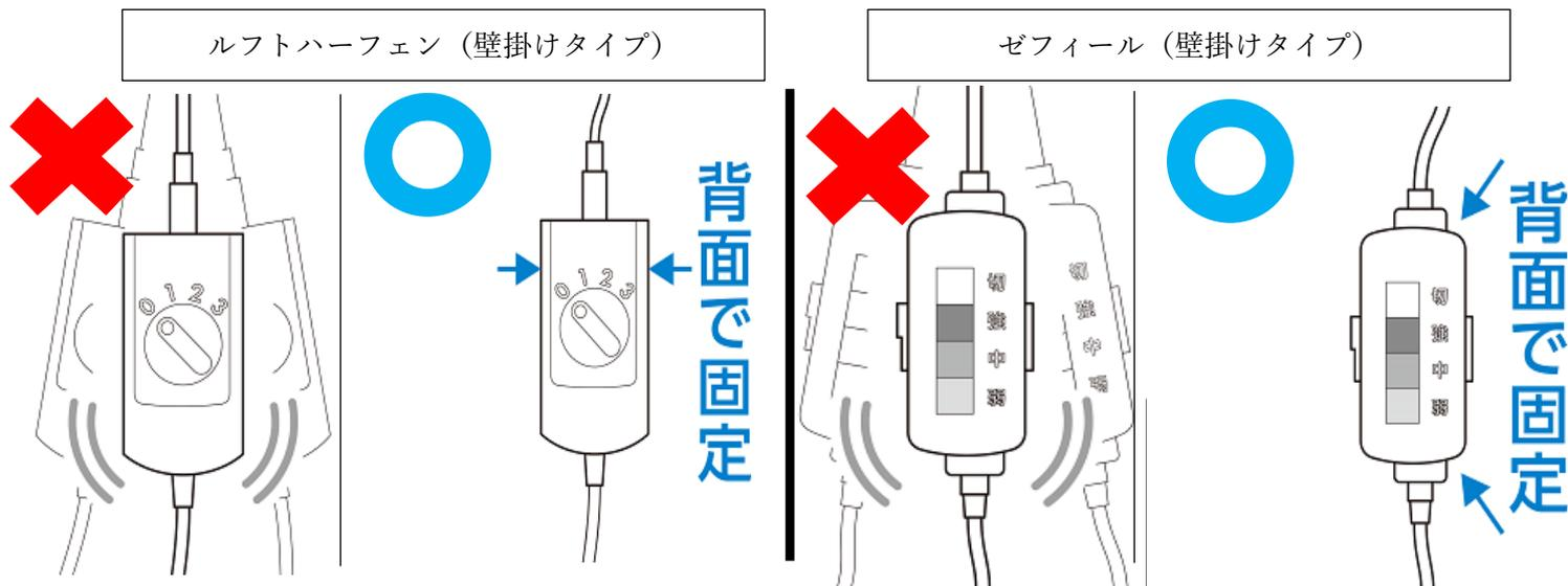
▲スイッチはぶら下げて使用せず、壁などに固定させて使用してください。また固定後、必ず電源コードにゆるみがあることをご確認ください。
