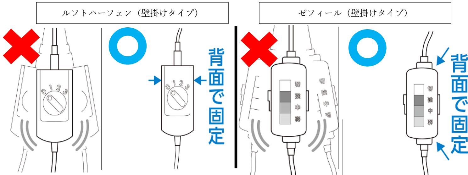
▲スイッチはぶら下げて使用せず、壁などに固定させて
