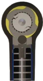
トルクレンチ内部構造
