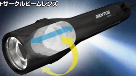
ヘッド部を回すと内部のLEDユニットが可動して照射角度を調節。本体が伸びないのでよけいな隙間ができず、十分な気密性を確保。Gシリーズのために設計されたサークルビームレンズとの組み合わせで美しい照射面を実現。 ※特許番号：第6232508号
