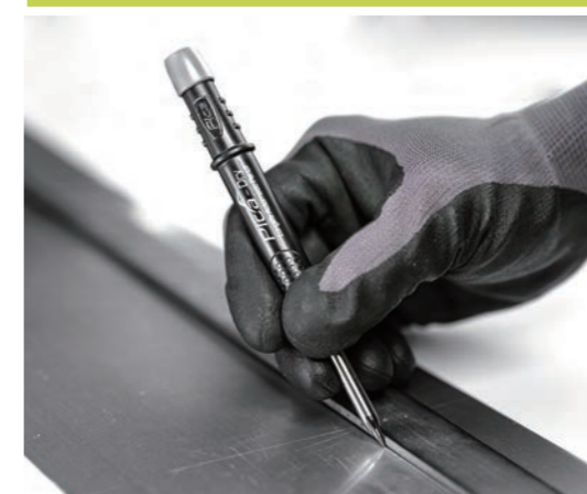
スクライバーニードルを使えば金属にもケガキ可能 (メタルセット・スクライバーニードルは別売りとなります)
