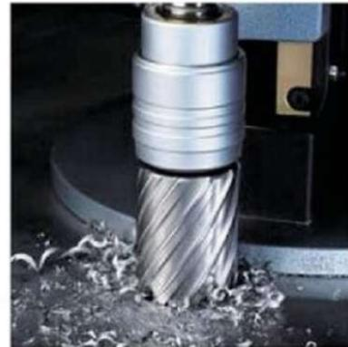
カーナッシュ Annular Cutter ata Karnasch ドイツ **磁気ボール盤カッター(アニュラーカッター)** **New** CO2 0.669
