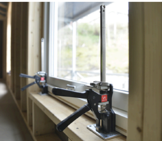
窓や窓枠、梁などの設置に。
