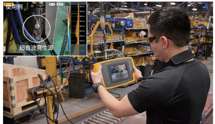
超音波でエア漏れの発生箇所を特定してモニターへ表示
